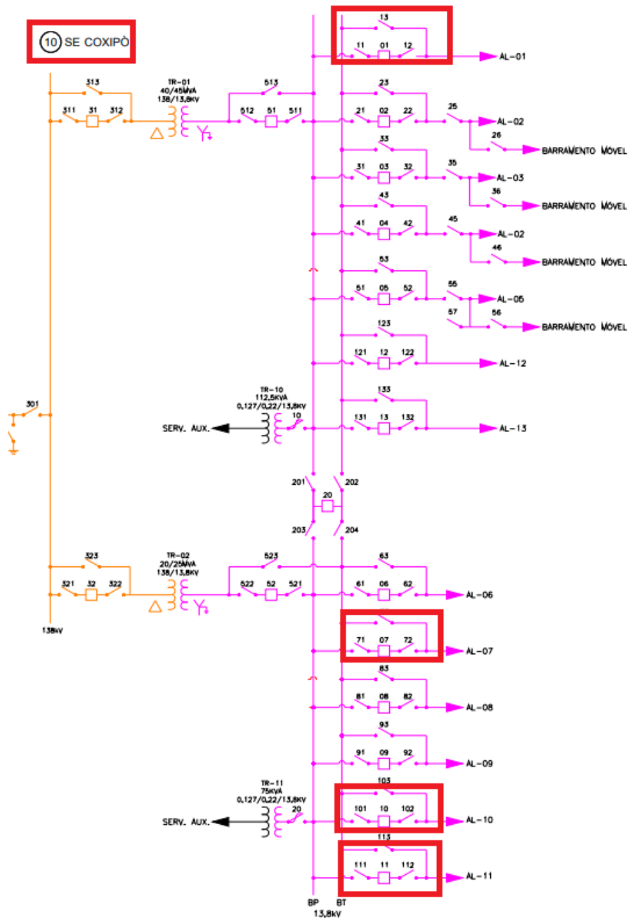
Figura 54 - Subestação COXIPO, alimentadores: 010001, 010007, 010010, 010011.
