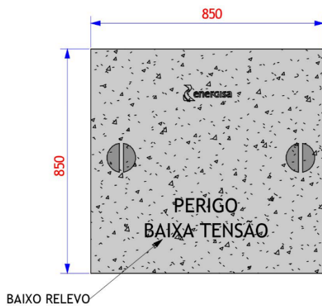
TAMPÃO DE CONCRETO
