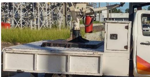
A face superior do compartimento deverá ser fabricada com chapa de alumínio xadrez de 2,7 mm espessura, soldada pelo processo MIG/MAG (GMAW) ou TIG (GTAW) e fixada à estrutura por meio de rebites de impacto ou rebites herméticos de liga adequada.
