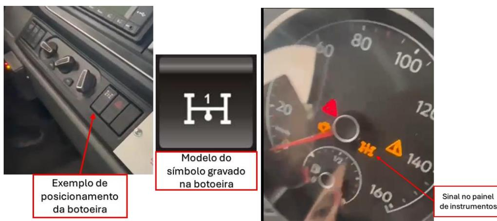
A parametrização da PTO deverá ser realizada com alguns dispositivos de proteção, de forma que alguns movimentos e acionamento simultâneos façam com que a PTO desacople imediatamente, não sendo possível utilizar o equipamento hidráulico, protegendo o conjunto. A PTO deverá desacoplar da caixa de câmbio no caso de desativação do freio de estacionamento (“soltar o freio de mão”) e ao acelerar o veículo a fim de obter maior rotação para o sistema hidráulico.
