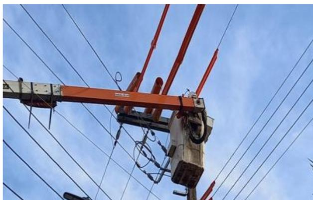
Em casos de não isolamento completa da lança telescópica, a seção isolada deverá possuir um comprimento mínimo de 2,7m (2700mm).
