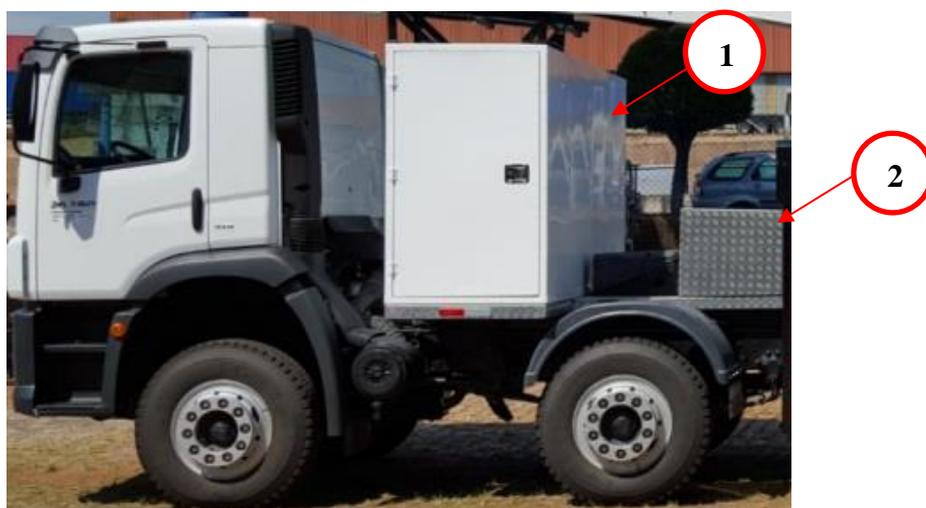
1. Para o compartimento imediatamente após cabine (1), deverá possuir uma divisão vertical ao meio e abertura com portas em ambos os lados, conforme abaixo, para acomodação de andaimes. O compartimento deverá possuir 940mm de largura por 1555mm de altura por 2100mm de comprimento.
