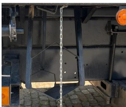
Em todo contorno de vão livre da carroceria deverá ser fabricada proteção Anti-Ciclista conforme imposta por legislação vigente.
