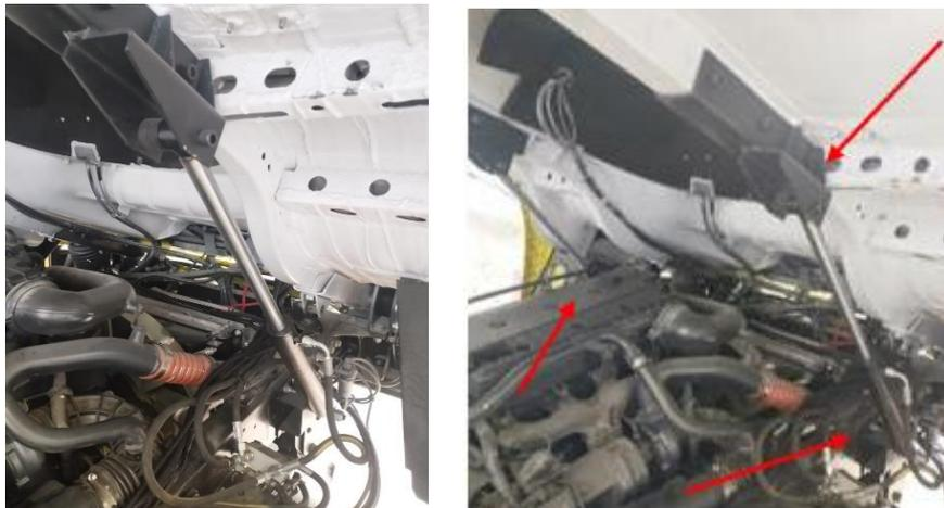
Para o basculamento e retorno da cabine, além dos cilindros de movimentação, deverá ser fornecido um macaco e reservatório hidráulicos compatíveis a instalação, devidamente fixados na estrutura do chassi do veículo, de fácil acesso e simples operação, sendo o mesmo preparado para os esforços exigidos e que facilite a operação. O macaco hidráulico deverá estar devidamente identificado com os sentidos de operação (sobe e desce), assim como orientações de uso.
