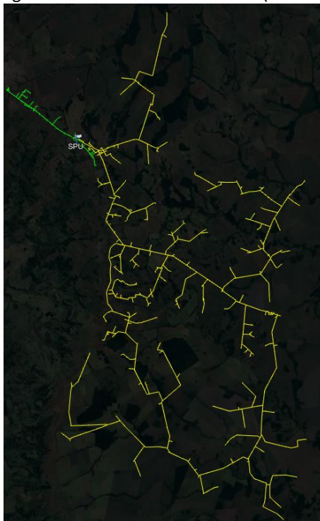
Figura 6 - Alimentadores afetados (SE SPU).
