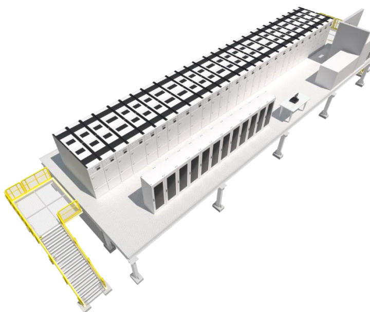
Figura 9: Modelo 3D da parte interna do eletrocentro do Tipo 01
