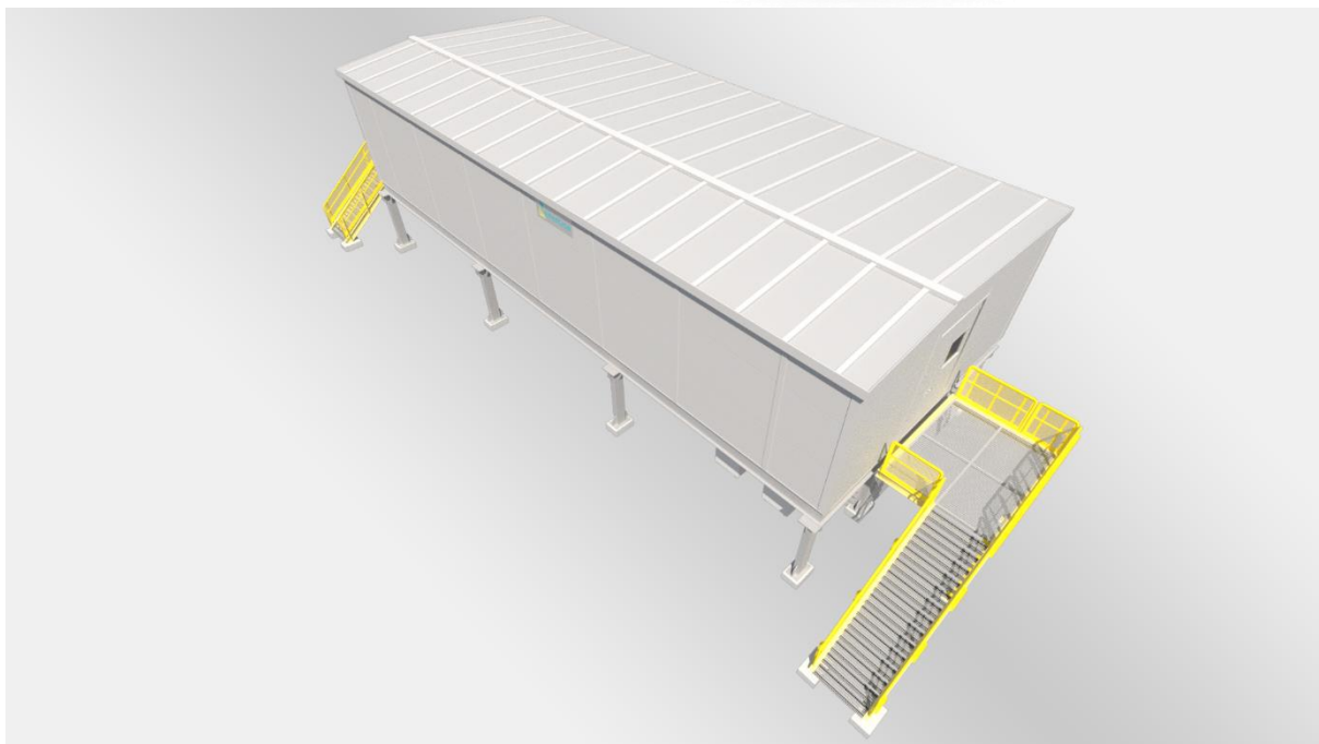
Figura 11: Modelo 3D da parte externa do eletrocentro do Tipo 01
