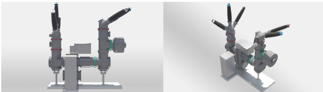
Figura 21: Representação 3D do bay linha-trafo
