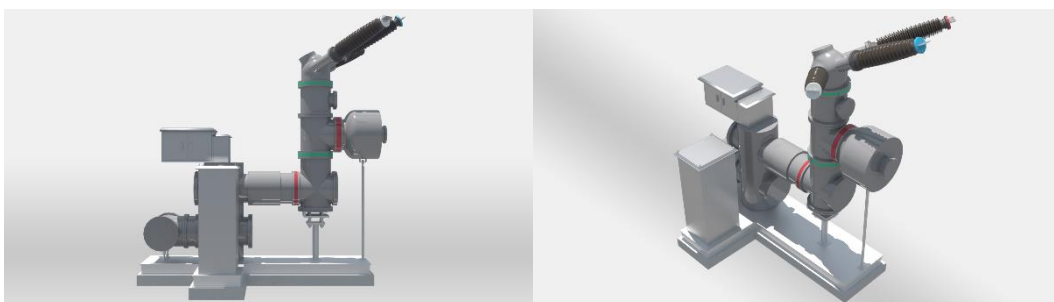
Figura 26: Representação 3D do bay de linha
