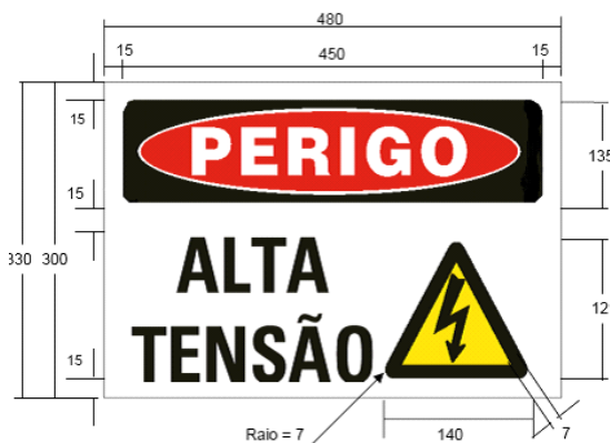
Figura 10: Sinalização de Perigo
