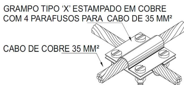
Figura 56: Detalhe de emenda em cruzamento com cabo de cobre na malha captora
