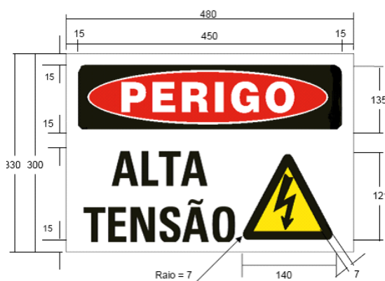
Figura 1: Sinalização de Perigo
