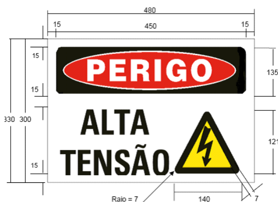
Figura 1: Sinalização de Perigo
