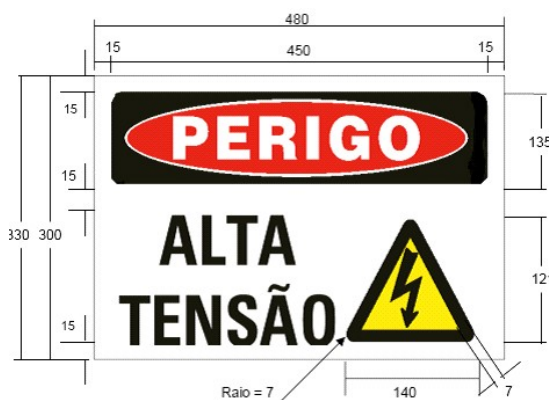
Figura 2: Sinalização de Perigo
