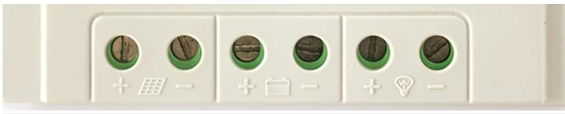
Figura 9 - Bornes do Controlador de Carga do tipo MPPT
