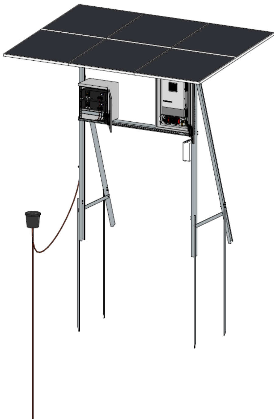
Figura 4 - Vista Oblíqua da Montagem
