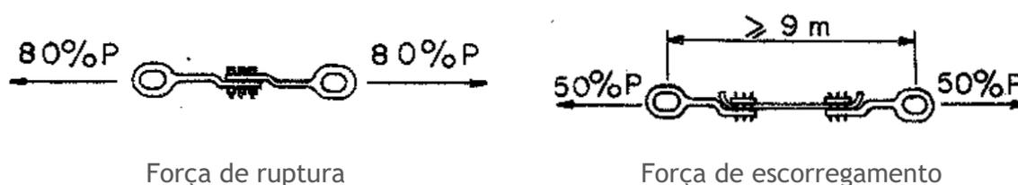
Figura 2 - Detalhe para execução do ensaio
