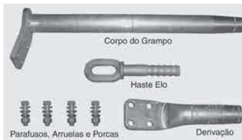
Figura 1 - Grampo de ancoragem a compressão
