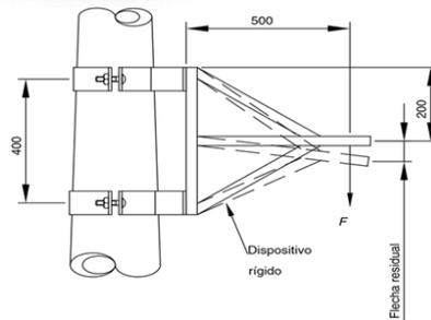
Figura 1 - Detalhe para execução do ensaio
