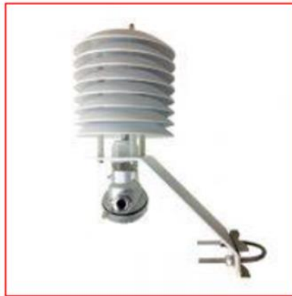
Figura B.9 - Exemplo de sensor de medição de temperatura ambiente
