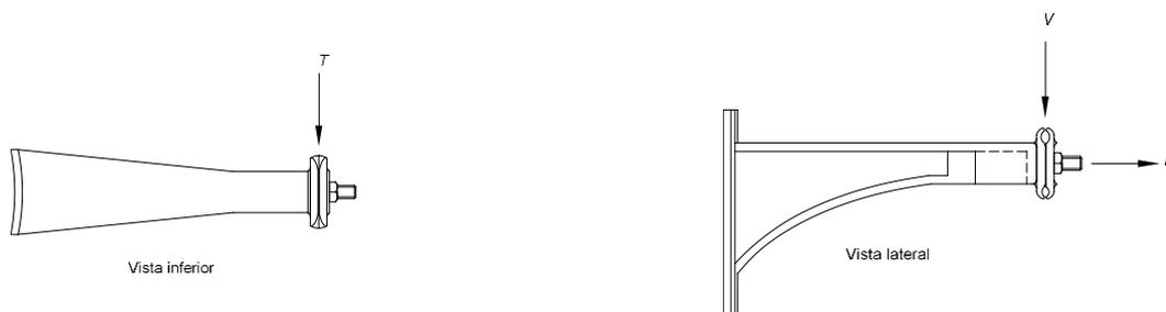
*Figura 1 - Detalhe para execução do ensaio*
