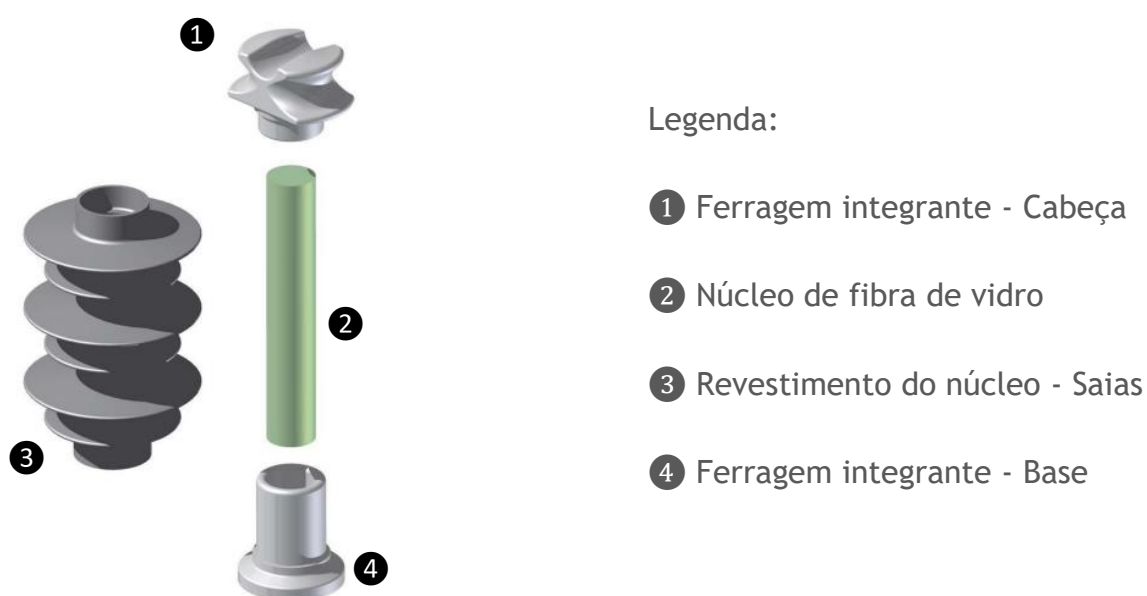
Figura 1 - Isoladores-pilares composto polimérico
